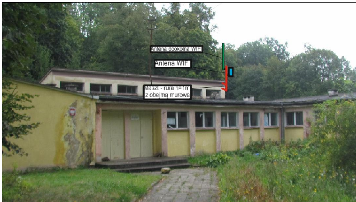
Rys. III.24. Projekt masztu wraz z antenami
