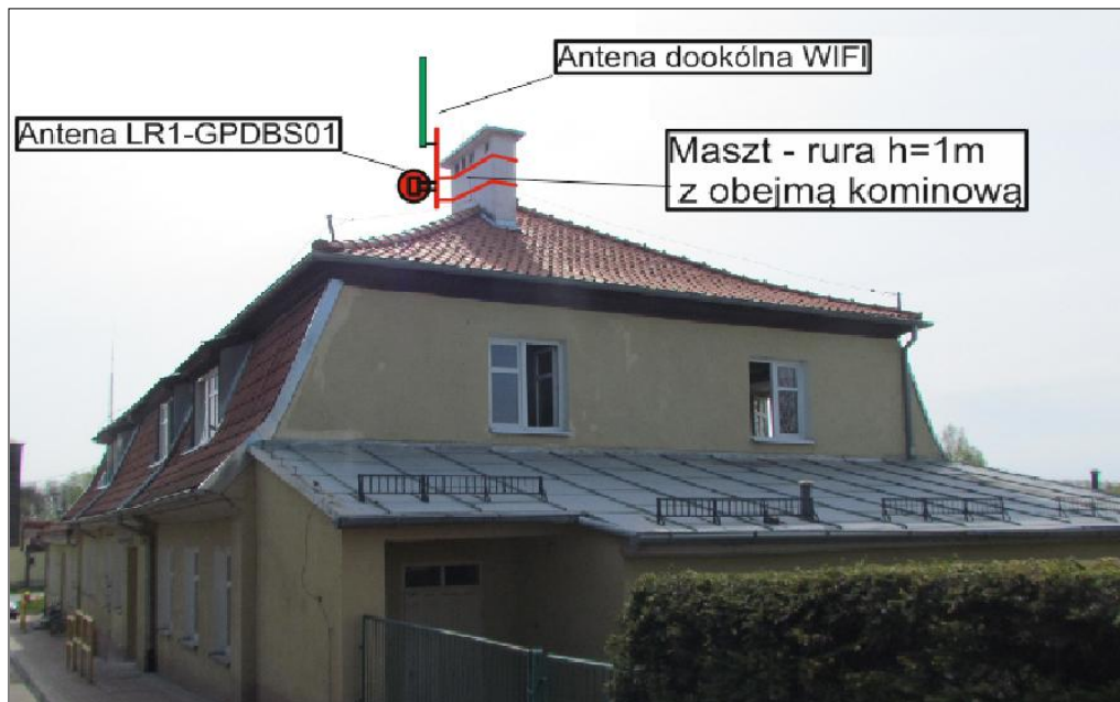
Rys. III.2. Schemat montażu anteny na dachu Urzędu Gminy
